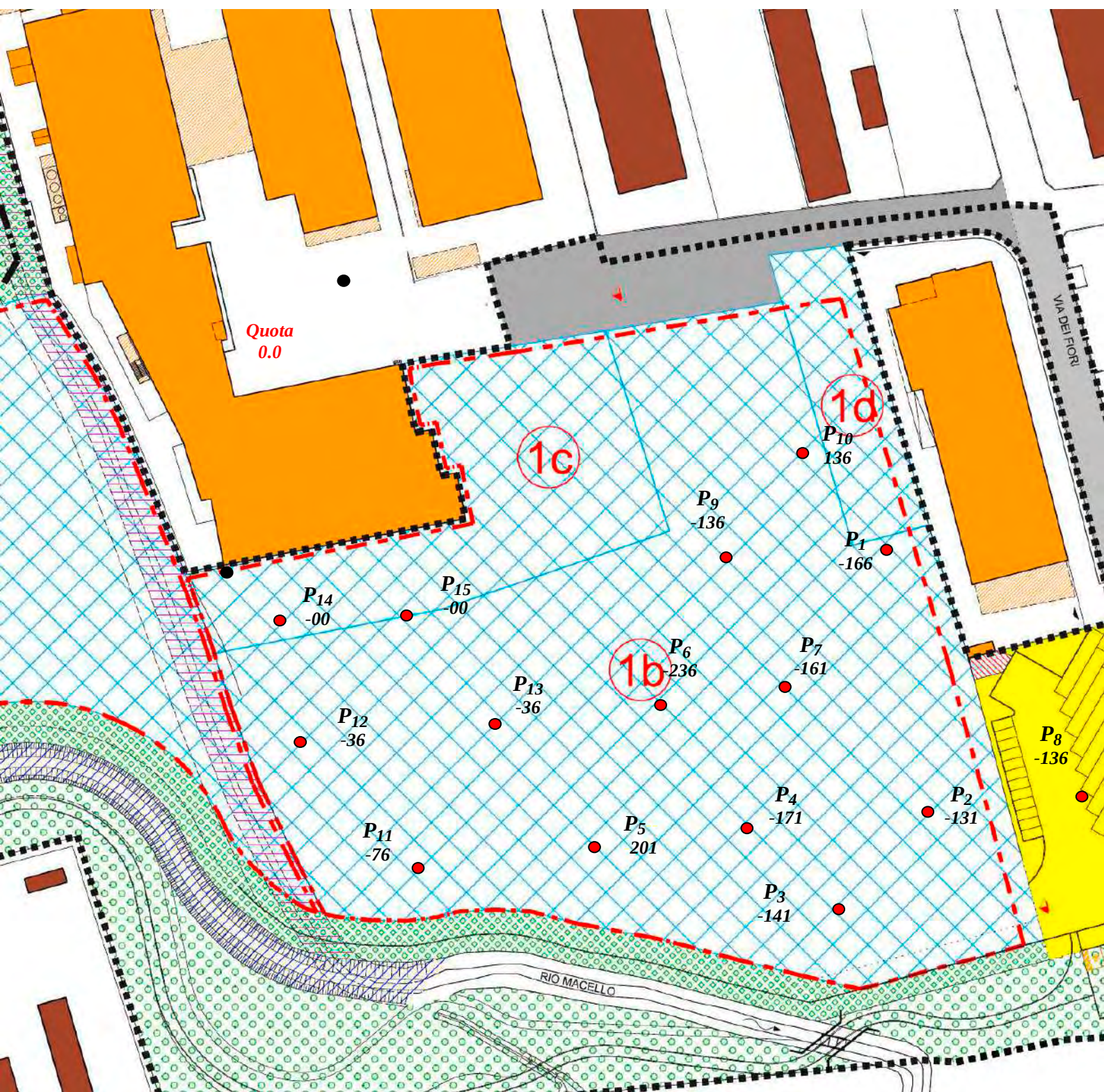
TAV.4 : Ubicazione delle prove penetrometriche su planimetria del fabbricato in ampliamento e quote del p.c. attuale da pavimento capannone esistente a NO
